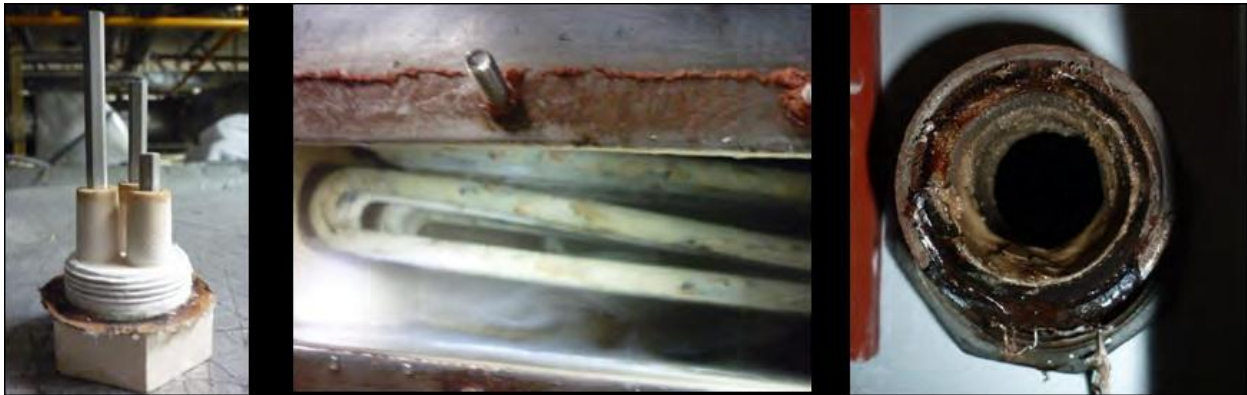
Hình 3.33: Bộ cảm biến ( sensor), thiết bị gia nhiệt và đường xả của máy hút ẩm không thấy cáu hình thành.
