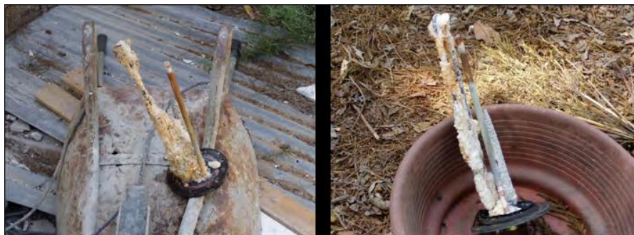
Figure 3.31: Một loại ống gia nhiệt điển hình không được bảo vệ ở Israel ( một địa điểm rất khó khăn về nước).
