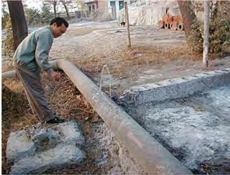
Hình 4.1: Một công nhân đo độ dày của lớp cáu trong đường ống bằng cách dùng một cây que đâm xuyên qua 1 cái lỗ trong đường ống. Phương pháp này chỉ dùng khi cáu đóng rất dày
