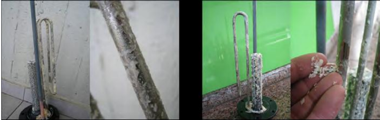
Hình 3.34: Những bộ gia nhiệt của máy nước nóng kiểu nhúng tại ký túc xá Đại học Tel Aviv university. Cáu không dính chặt vào thiết bị và dễ dàng bong ra
