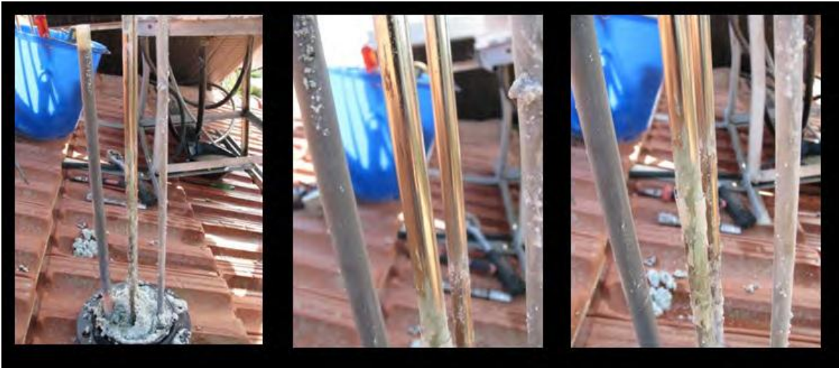
Hình 3.30: Các bộ gia nhiệt của các bộ đun nước nhúng chìm tại Son of the South village. Các mảng cấu bông ra từ bộ gia nhiệt
